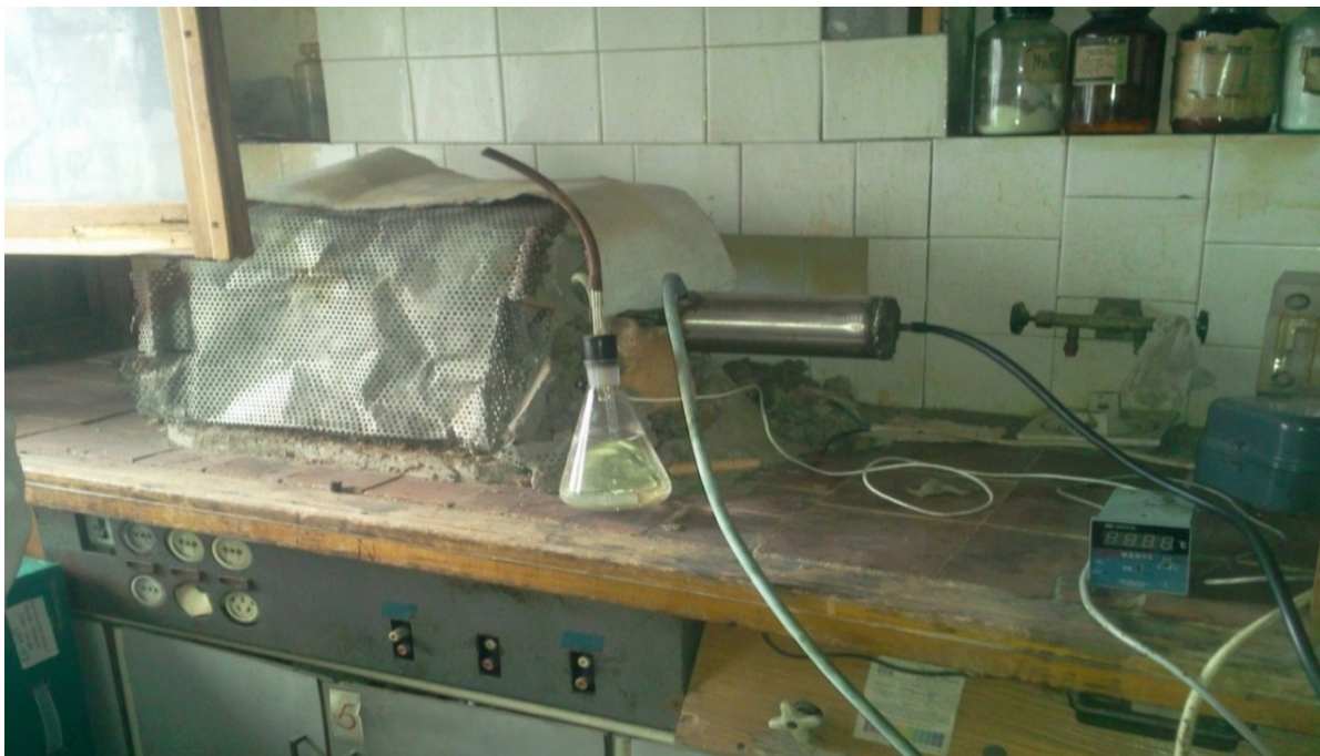
Рис.1 – Лабораторная печь для проведения пиролизной обработки НФО
